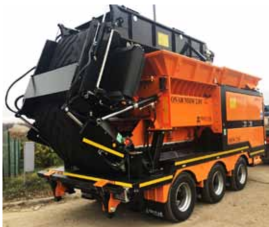
Kompostownia wyposażona jest m.in. w dwa nowoczesne młyny służące do rozdrabniania większych odpadów
